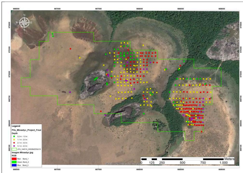
Figure 1 : Total de 361 puits identifiés dans la propriété de Minastyc, classés par profondeur.
